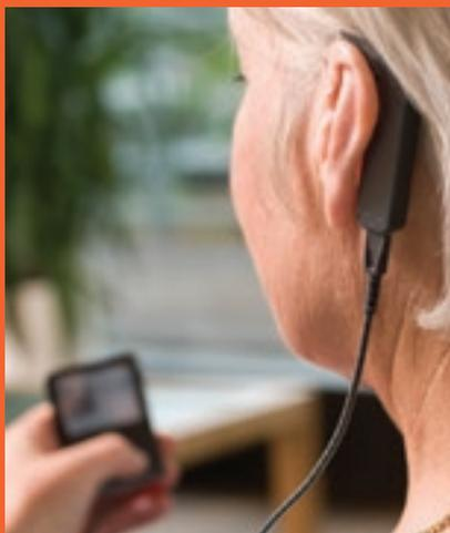
Uso de la conexión directa con un cable de audio (arriba a la derecha)
